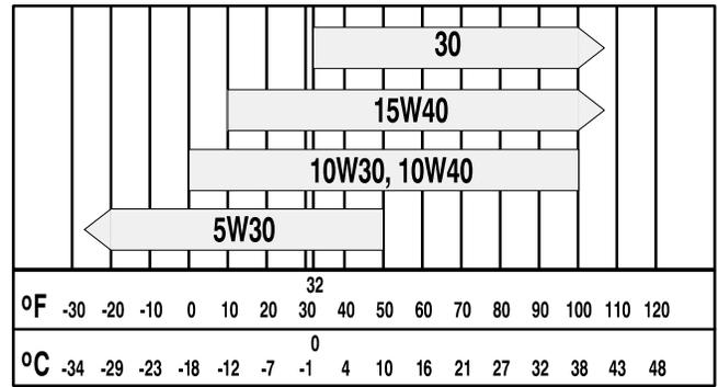
FIGURE 2. SAE VISCOSITY GRADE vs. AMBIENT TEMPERATURE
