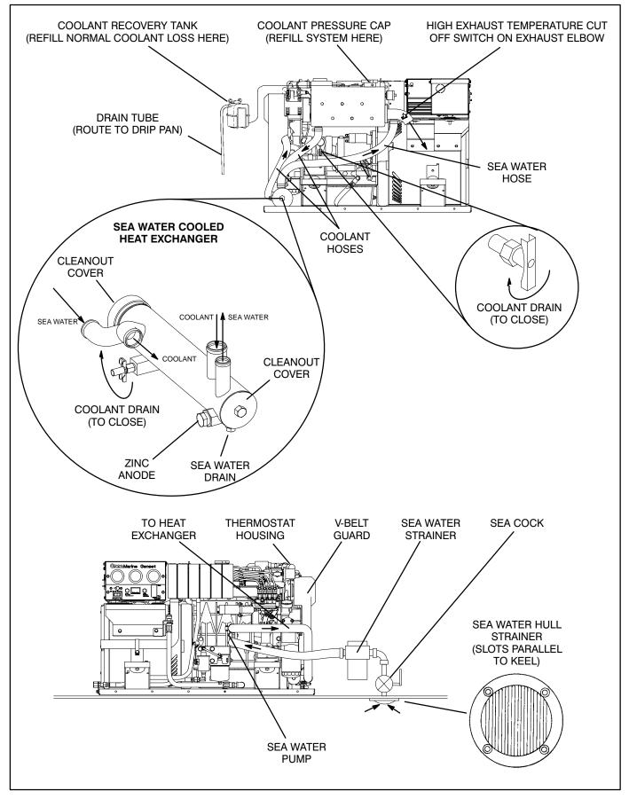
FIGURE 5. TYPICAL HEAT EXCHANGER-TYPE COOLING SYSTEM
