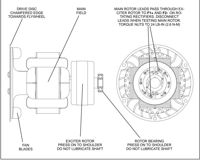
**FIGURE 20. ROTOR ASSEMBLY**
